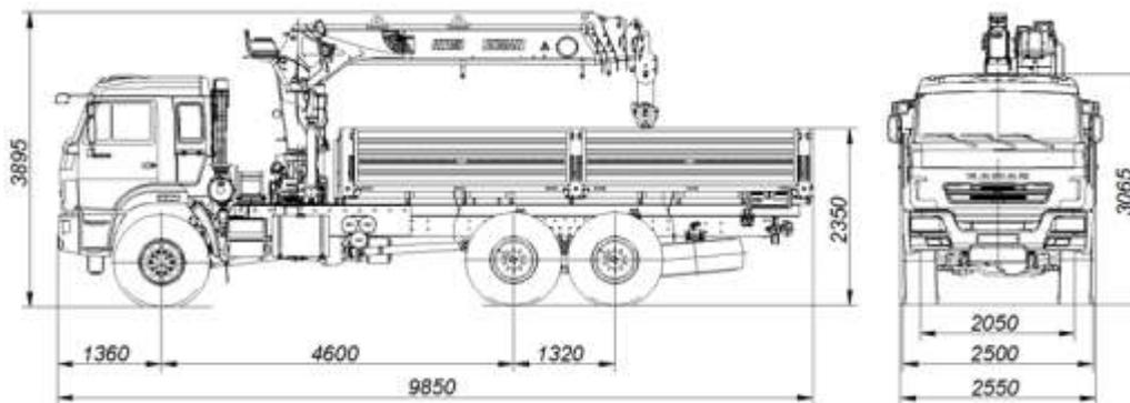
Размеры для автомобиля снаряженной массы: - с шинами 425/85R21
